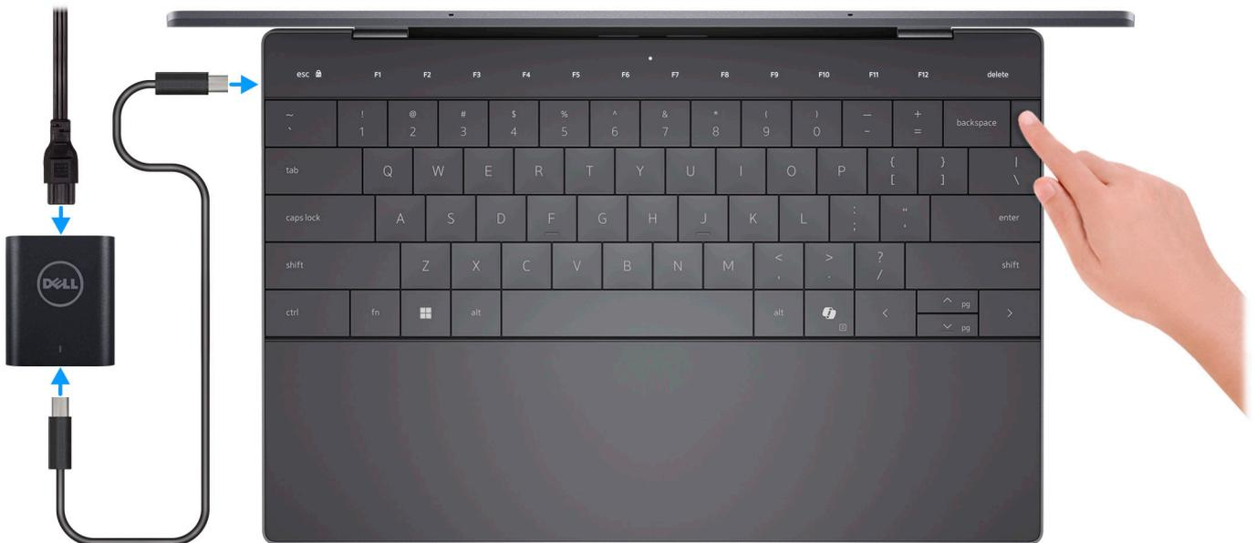
Abbildung 7. Schließen Sie den Netzadapter an und drücken Sie den Betriebsschalter.
