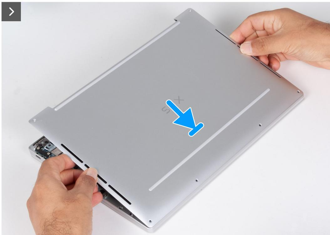
Abbildung 16. Anbringen der Bodenabdeckung
