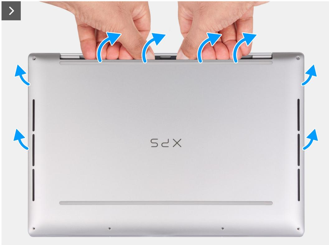
Abbildung 14. Entfernen der Bodenabdeckung
