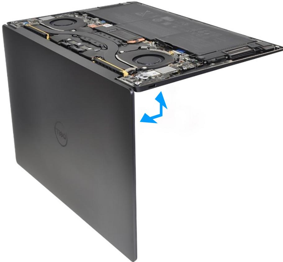
**Abbildung 45. Öffnen der Bildschirmbaugruppe in einem 90-Grad-Winkel**
