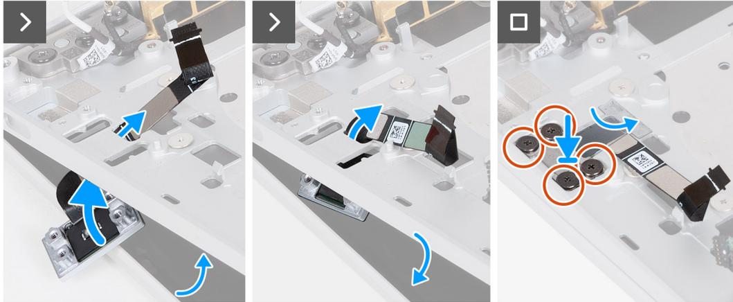
Abbildung 46. Einbauen des Netzschalters mit Fingerabdruck-Lesegerät
