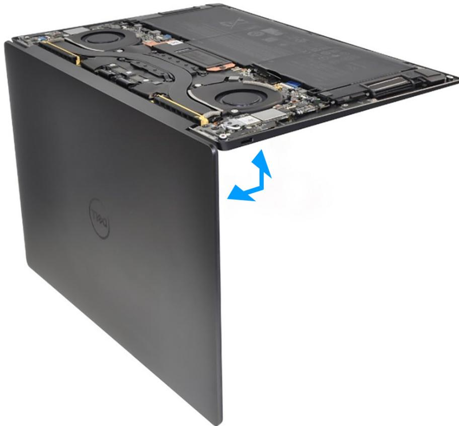
**Abbildung 39. Öffnen der Bildschirmbaugruppe in einem 90-Grad-Winkel**
