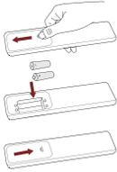
1. Öffnen Sie das Batteriefach der Fernbedienung.
