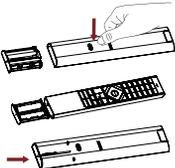
1. Drücken, damit klappt das Batteriefach automatisch auf.
