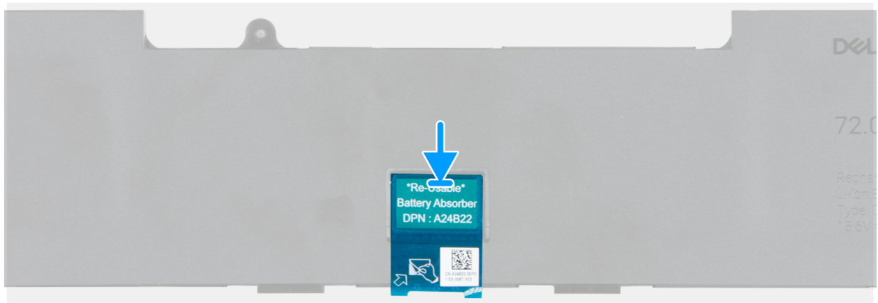
Abbildung 20. Einbauen des Batterieabsorbers
