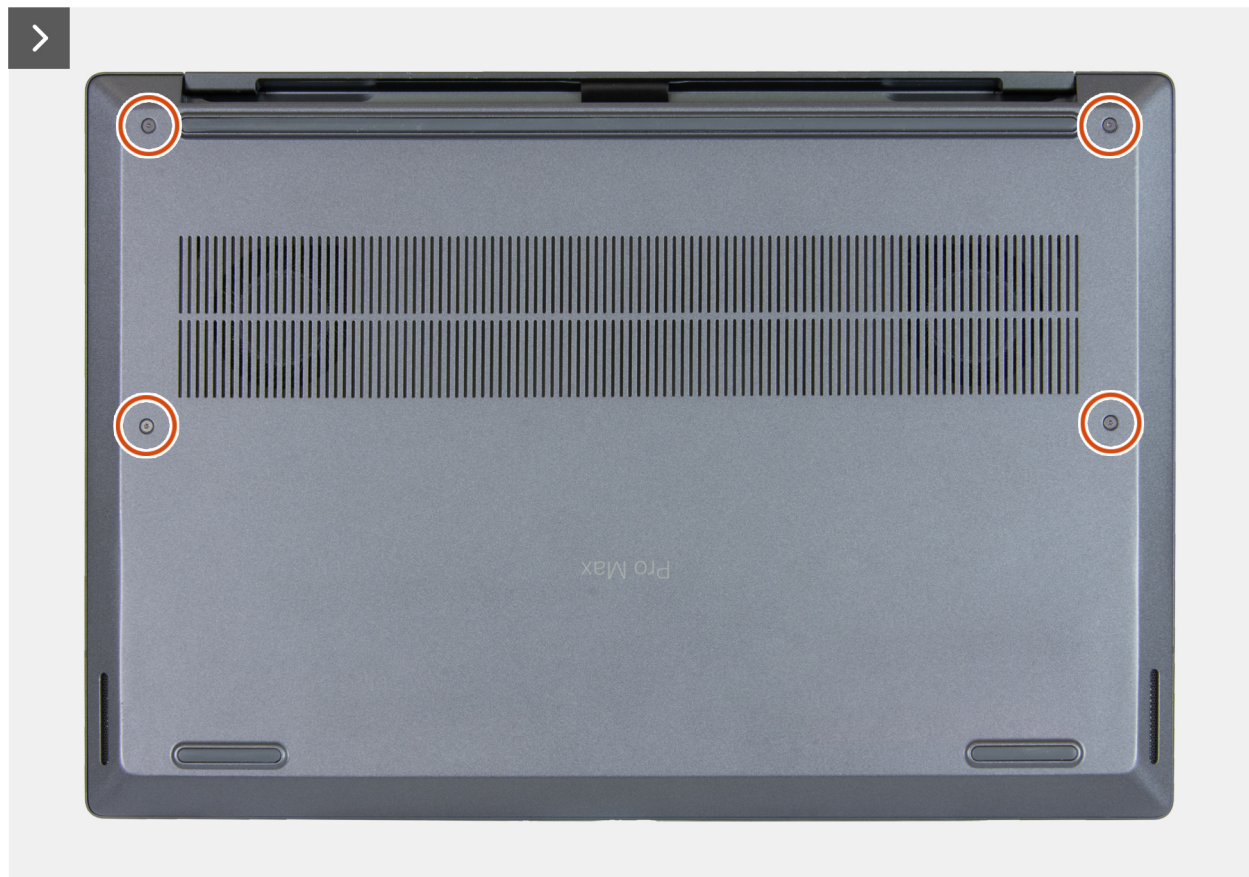
Abbildung 12. Entfernen der Bodenabdeckung
