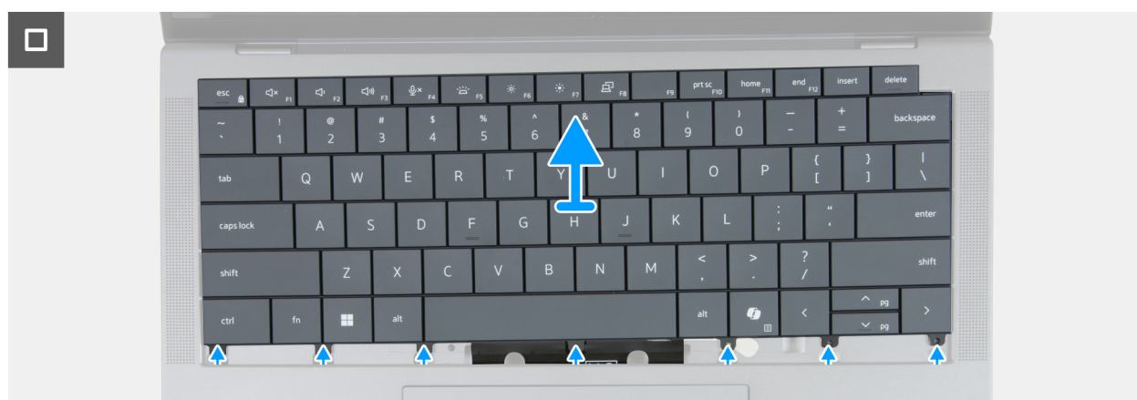
Abbildung 72. Entfernen der Tastatur
