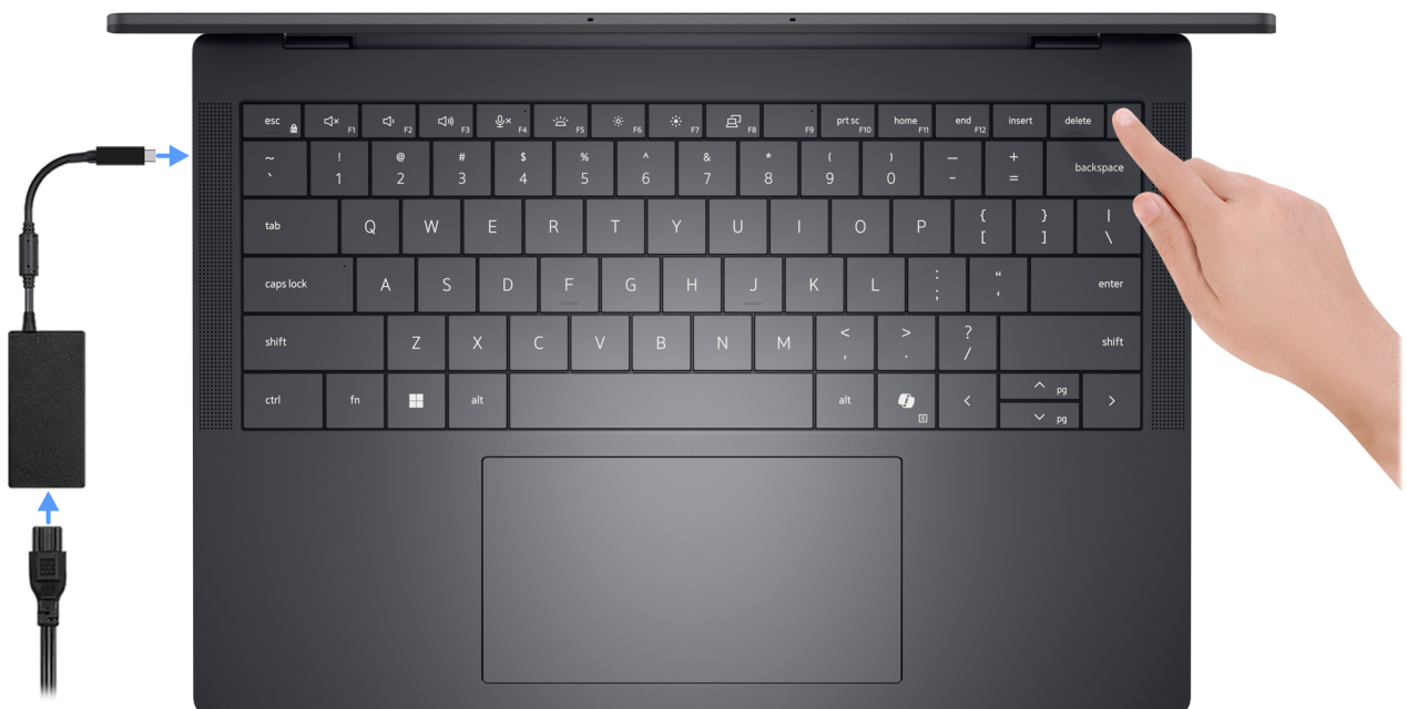
Abbildung 8. Anschließen des Netzteils und Drücken des Netzschalters
