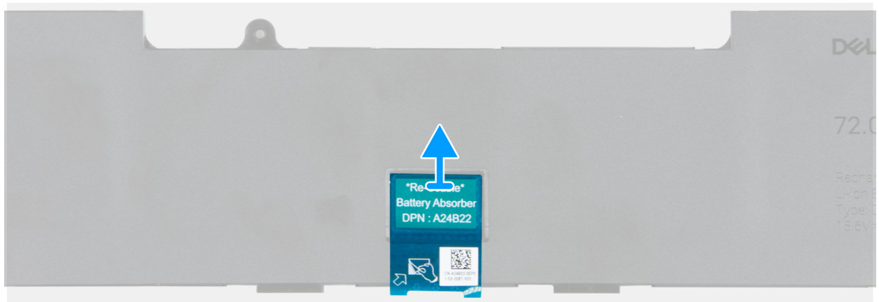
Abbildung 18. Entfernen des Batterieabsorbers
