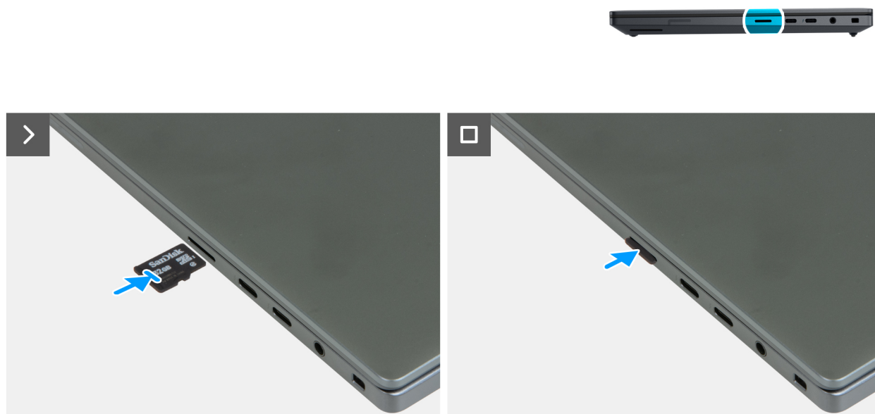
Abbildung 11. Einsetzen der Speicherkarte
