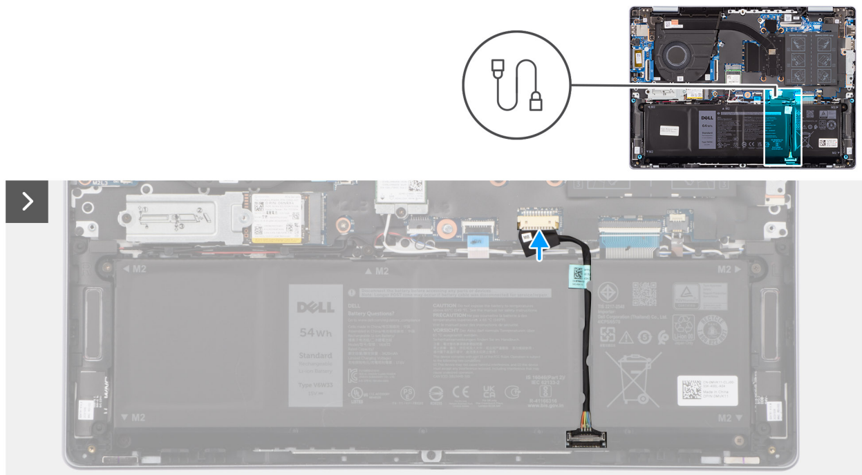
Abbildung 16. Verbinden des Akkukabels
