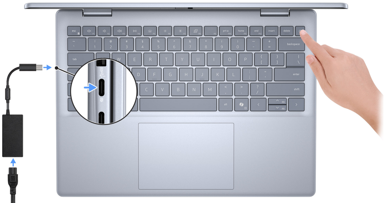
Abbildung 11. Schließen Sie das Netzteil an und drücken Sie den Netzschalter.
