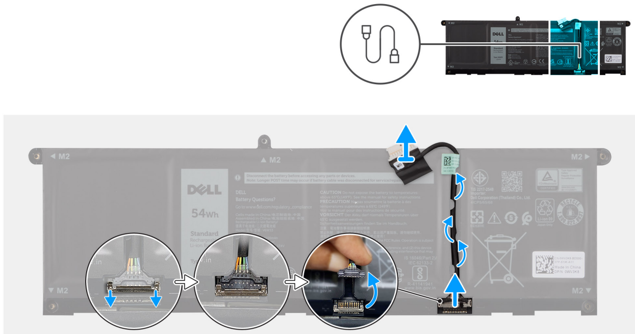
Abbildung 29. Trennen des Akkukabels
