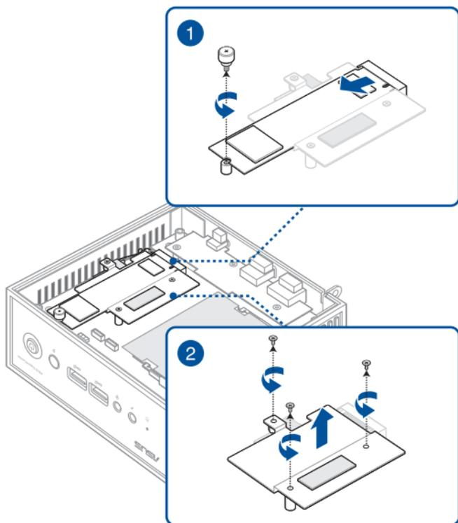
3. Richten Sie die WLAN-Karte am entsprechenden Steckplatz im Mini PC aus und stecken Sie sie ein. Drücken Sie dann die WLAN-Karte vorsichtig über dem Abstandsbolzen herunter.
