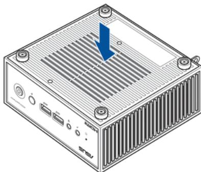
2. Befestigen Sie die untere Abdeckung mit den vier (4) Schrauben.
