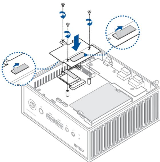
8. (optional) Installieren Sie wieder das M.2 SSD, falls dieses zuvor entfernt wurde.
