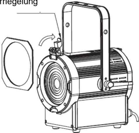
2. Schieben Sie die Klappe von oben in die 3 Klappenrillen.
