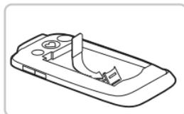
1. Entfernen Sie den Akku-Deckel (Ausnehmung links oben).
