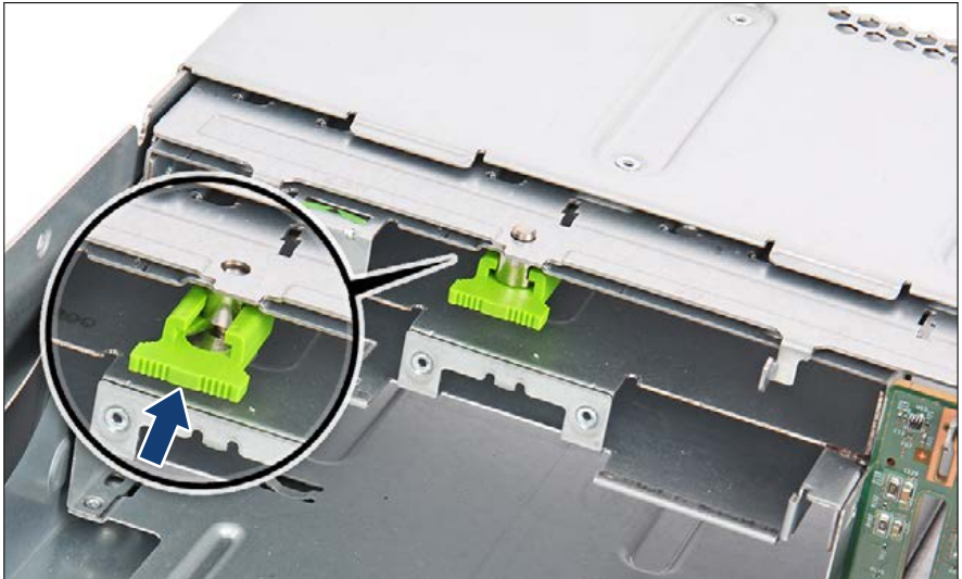
Bild 303: Frontpanel-Käfig einbauen (B)
