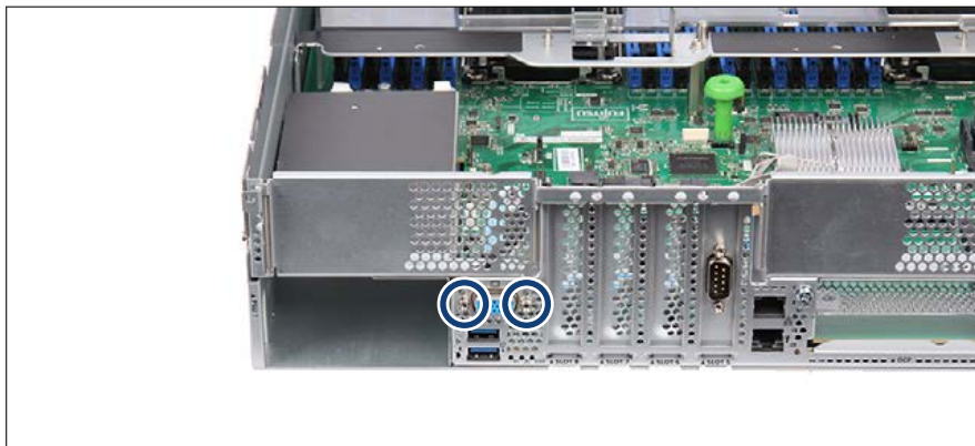
Bild 328: Hinteren VGA-Anschluss entfernen (A)
