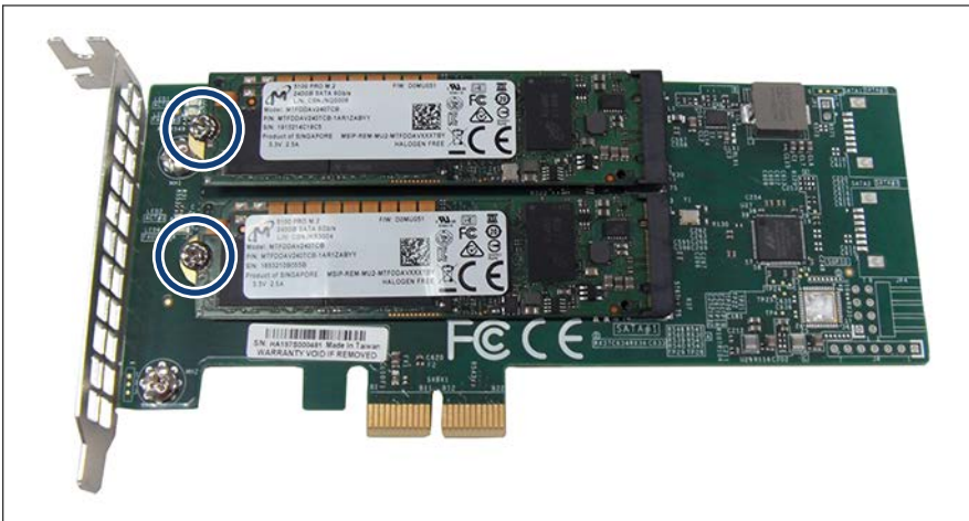
Bild 155: M.2-SSDs einbauen (B)
