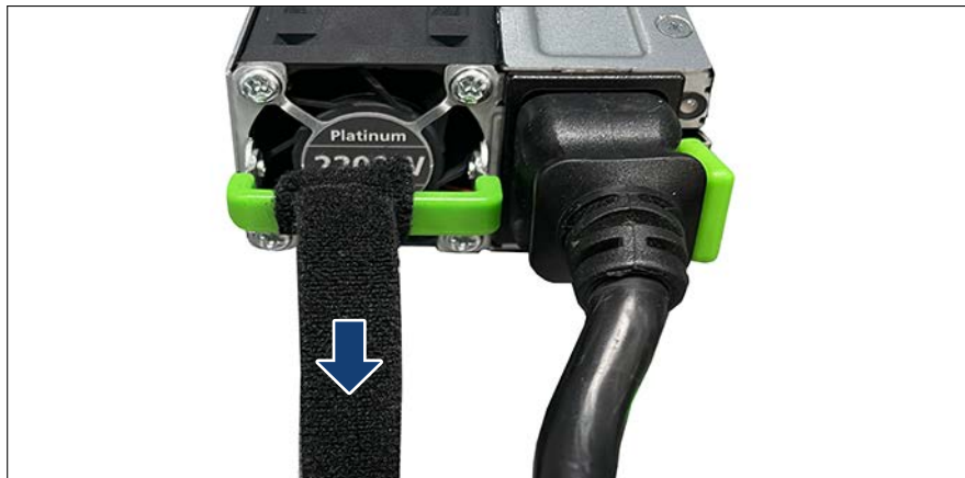
Bild 18: Netzkabel mit dem Klettband sichern (A)
