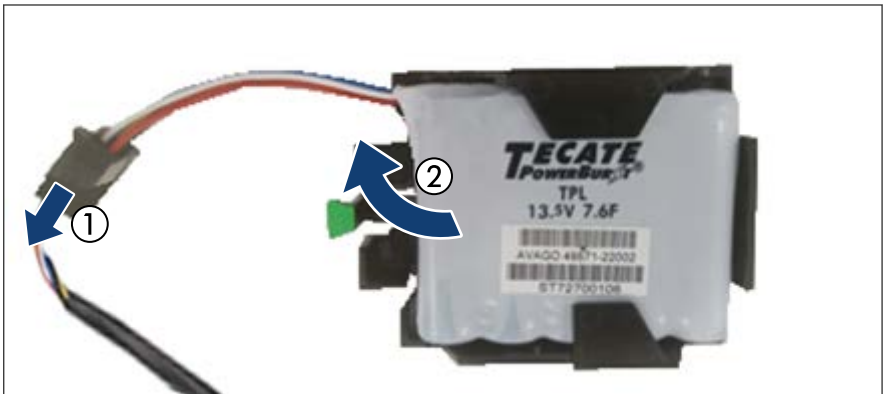
Bild 192: FBU aus der Halterung entfernen
