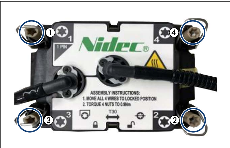
Bild 232: LC-Kühlkörper entfernen (A)
