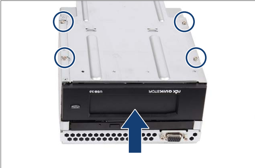
Bild 292: RDX-Laufwerk einbauen (A)
