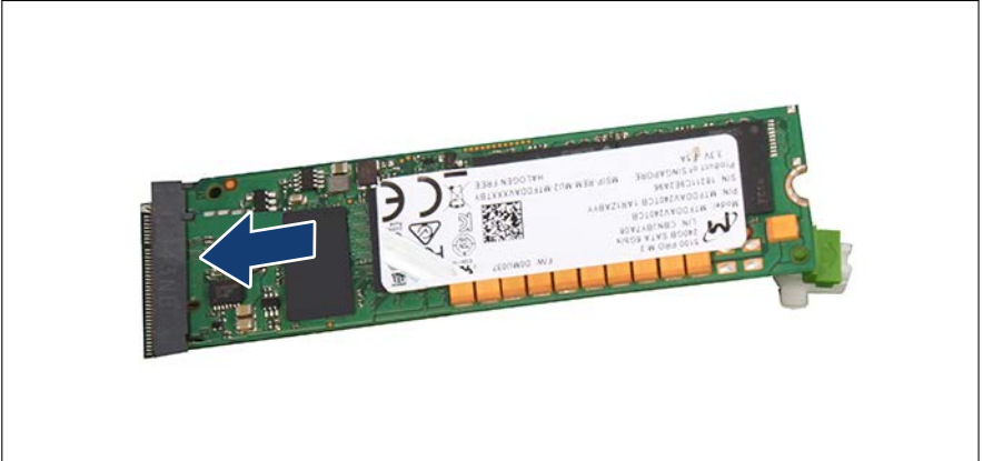
Bild 107: M.2-SSD einbauen (A)
