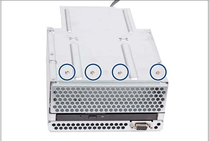
Bild 301: Lüftungsgitter einbauen (B)
