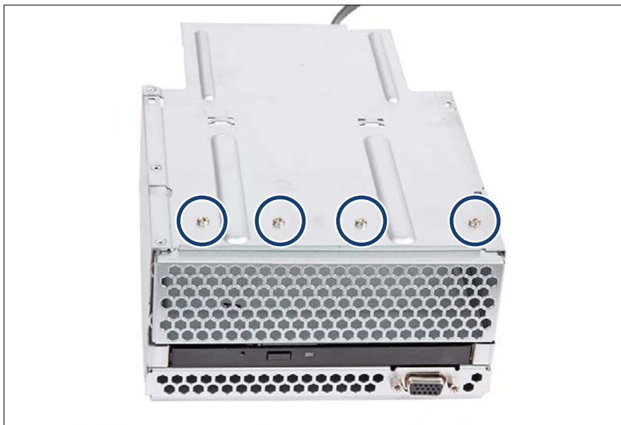
Bild 290: Lüftungsgitter entfernen (A)
