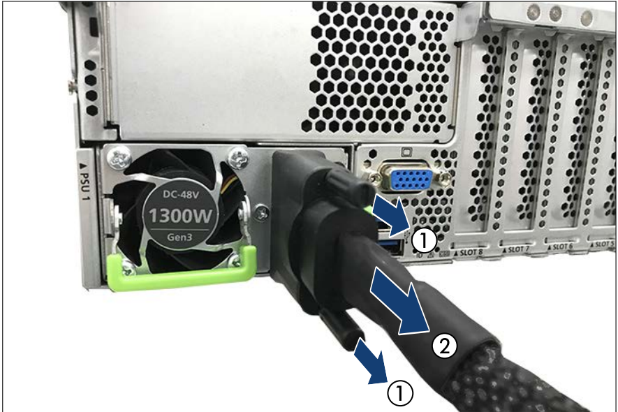
Bild 6: Server von der Gleichstromquelle trennen - Beispiel DC-Netzteil -48 V
