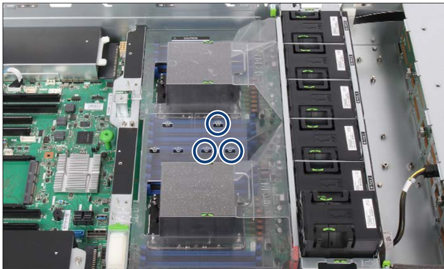
Bild 189: Bolzen an der Lufthaube
