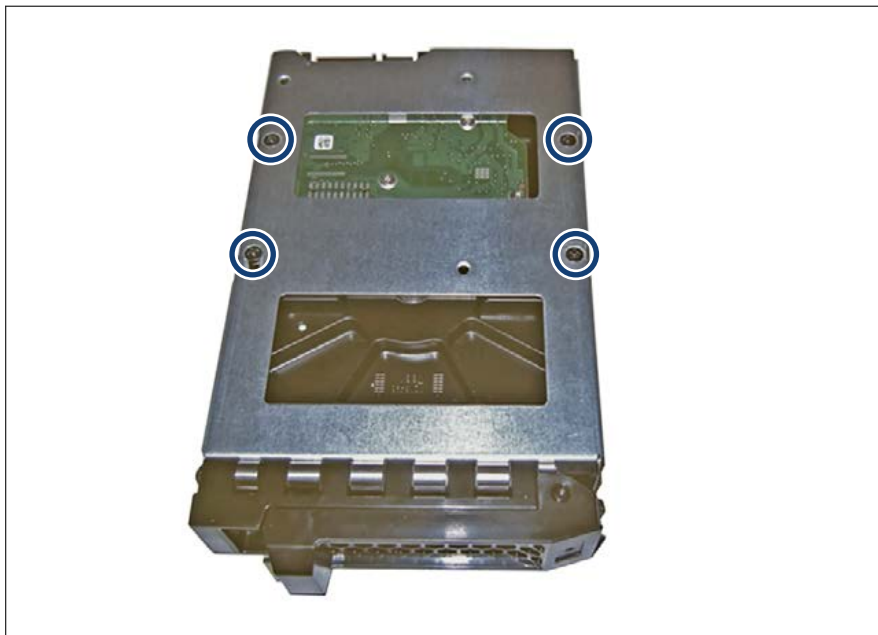
Bild 53: 3,5-Zoll-HDD in einen 3,5-Zoll-Einbaurahmen einbauen (B)
