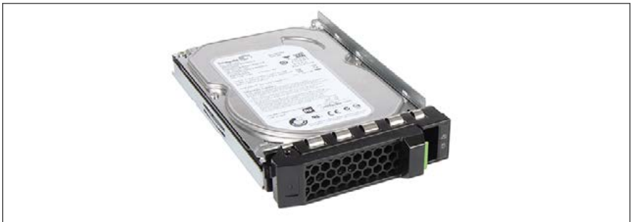
Bild 52: 3,5-Zoll-HDD in einen 3,5-Zoll-Einbaurahmen einbauen (A)
