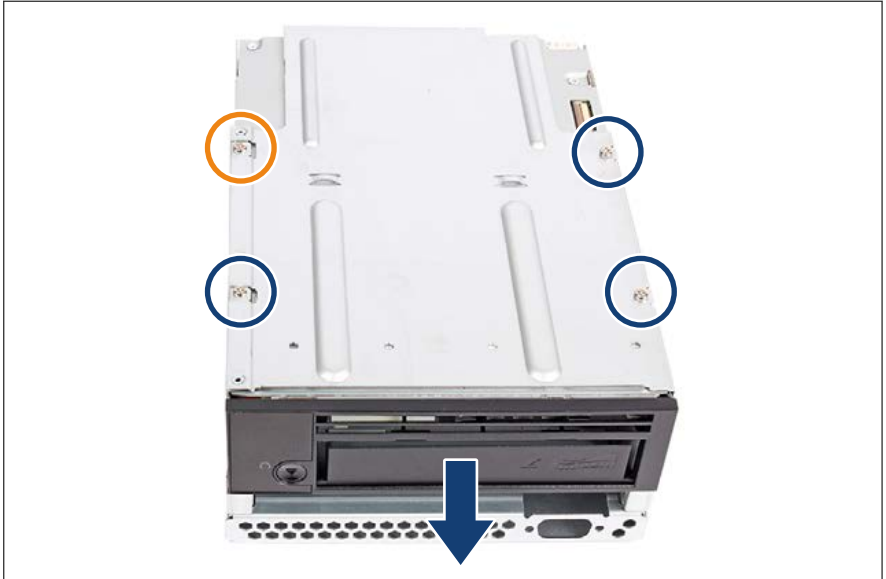
Bild 283: LTO-Laufwerk entfernen (C)
