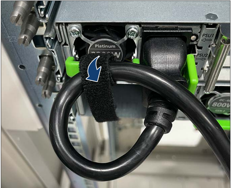
Bild 19: Netzkabel mit dem Klettband sichern (B)
