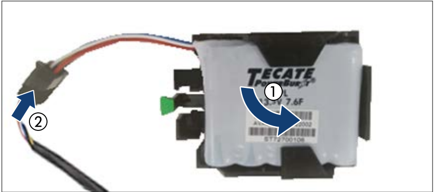
Bild 188: FBU in die Halterung einbauen
