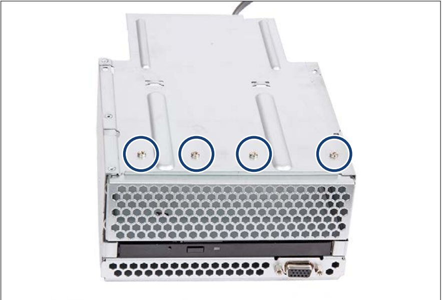
Bild 274: Lüftungsgitter entfernen (A)
