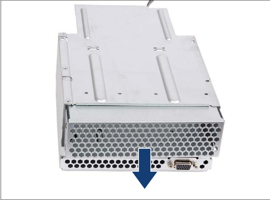
Bild 275: Lüftungsgitter entfernen (B)
