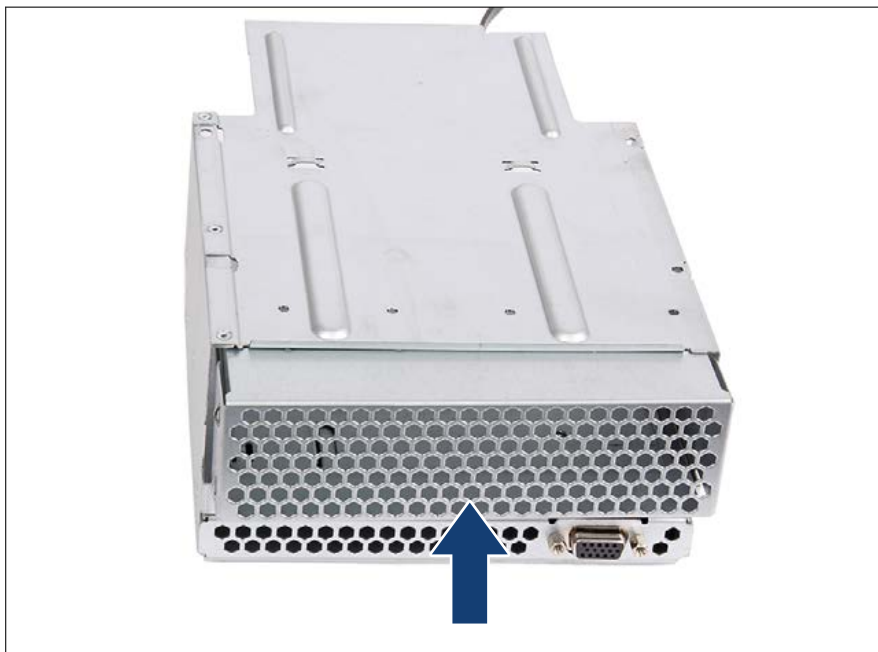
Bild 284: Lüftungsgitter einbauen (A)
