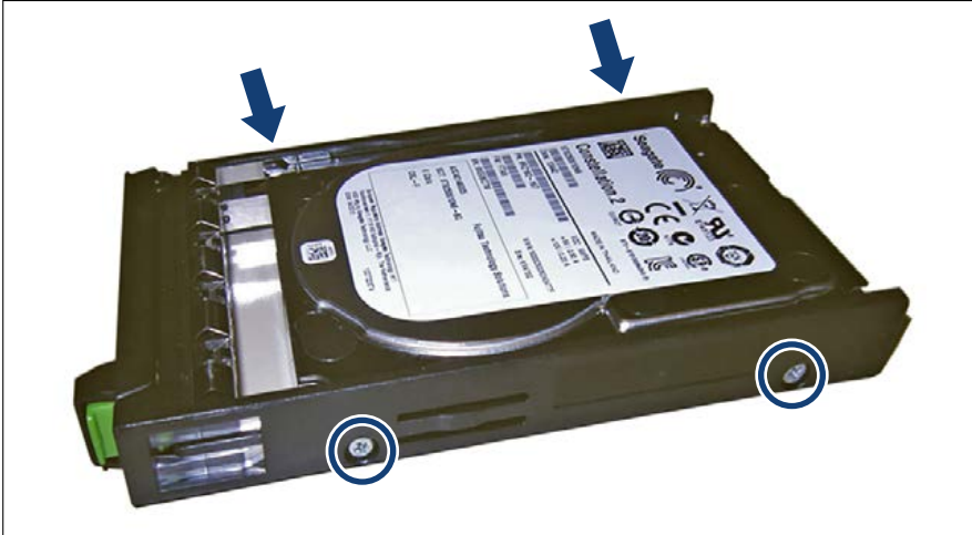
Bild 55: 2,5-Zoll-HDD/-SSD in einen 2,5-Zoll-Einbaurahmen einbauen (B)
