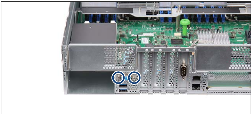
Bild 331: Hinteren VGA-Anschluss einbauen (B)
