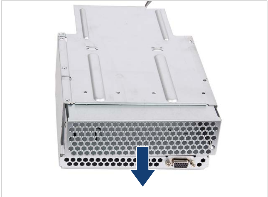
Bild 291: Lüftungsgitter entfernen (B)
