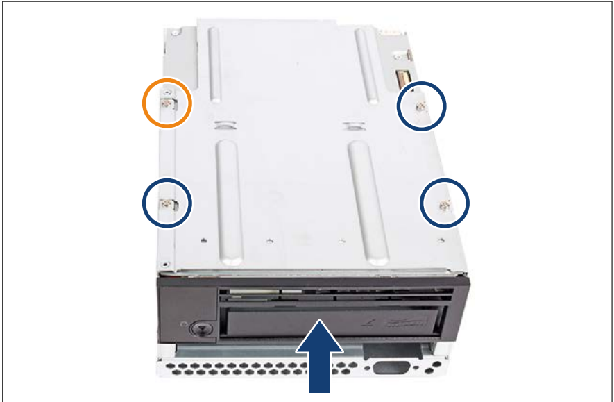
Bild 276: LTO-Laufwerk einbauen (A)
