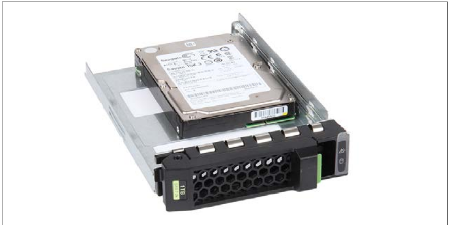
Bild 56: 2,5-Zoll-HDD/-SSD in einen 3,5-Zoll-Einbaurahmen einbauen (A)
