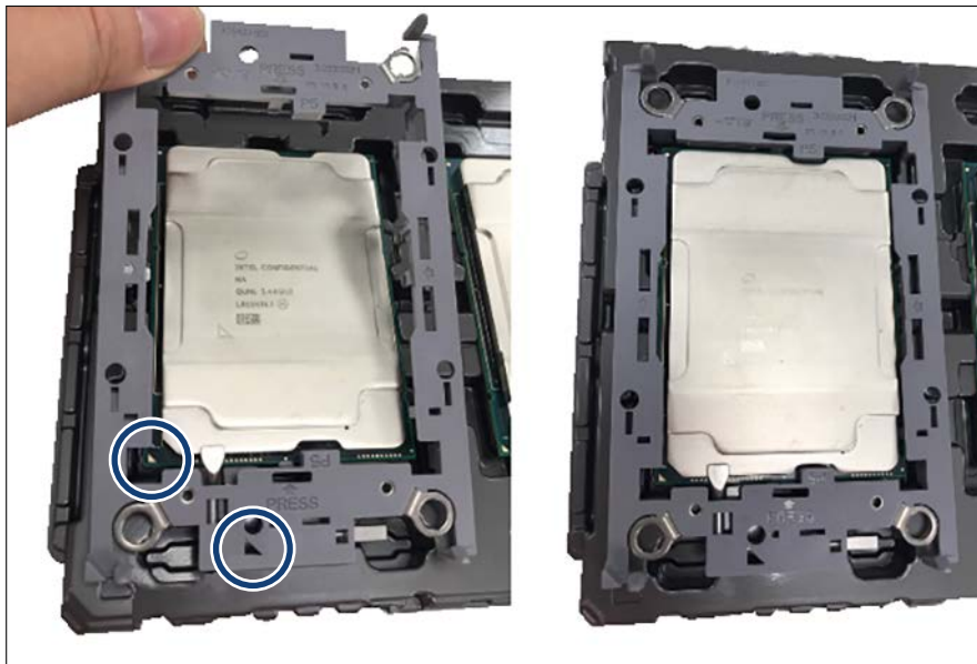
Bild 215: CPU-Rahmen auf dem Kühlkörper einbauen
