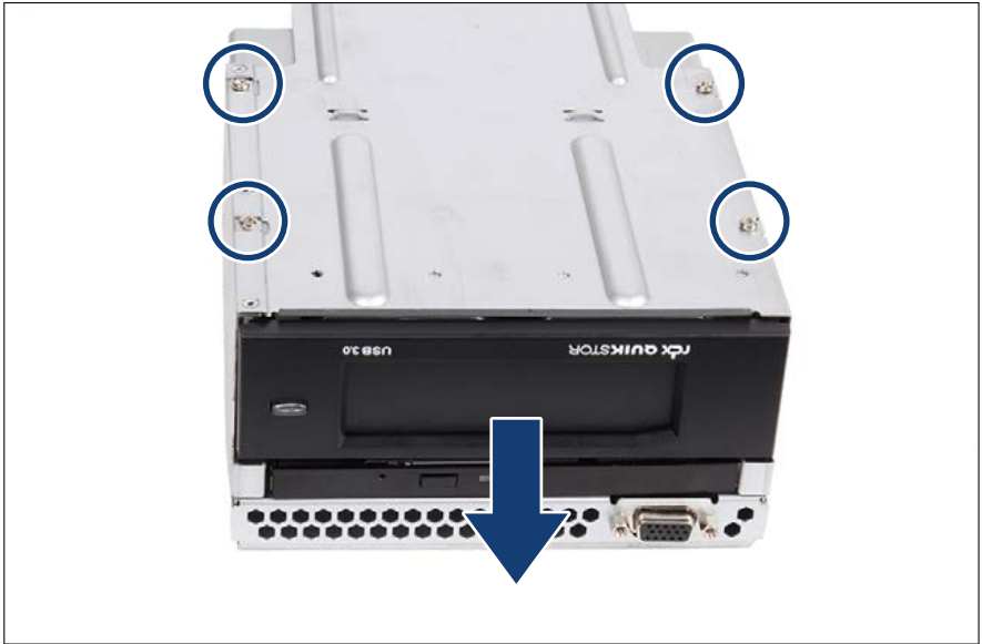
Bild 299: RDX-Laufwerk entfernen (C)
