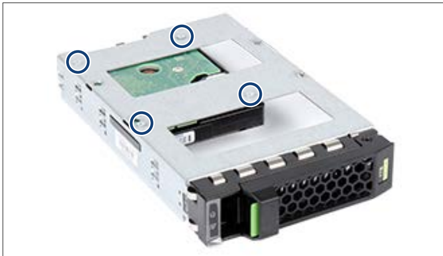
Bild 57: 2,5-Zoll-HDD/-SSD in einen 3,5-Zoll-Einbaurahmen einbauen (B)
