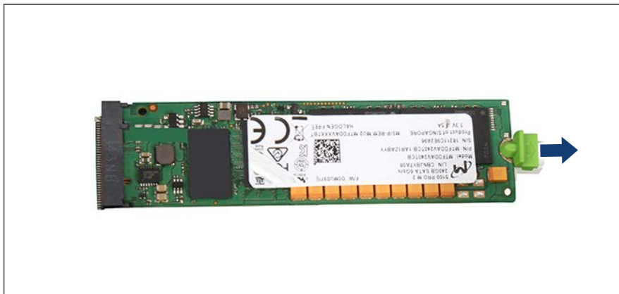
Bild 109: M.2-SSD entfernen (A)
