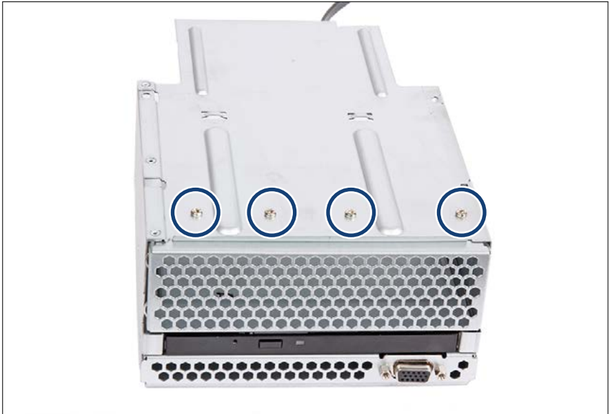
Bild 285: Lüftungsgitter einbauen (B)
