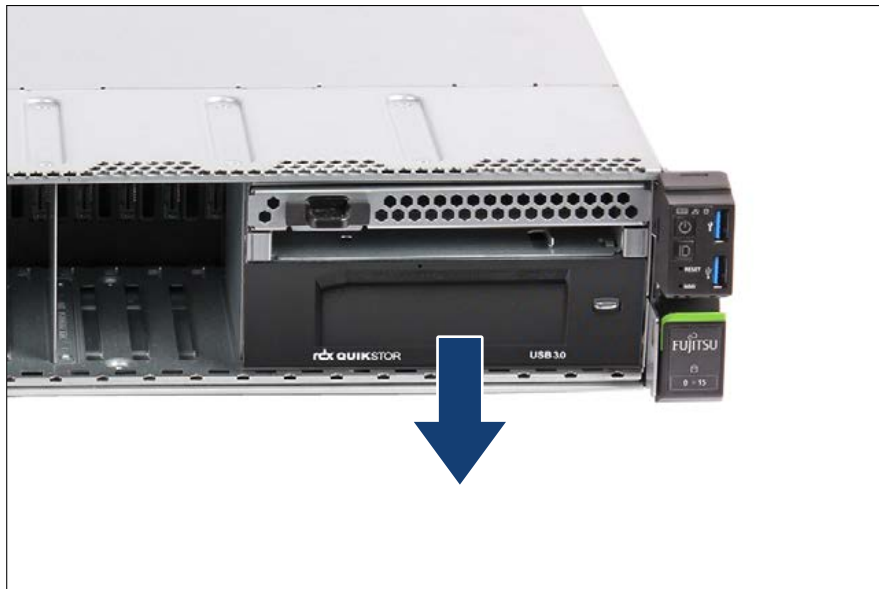
Bild 298: RDX-Laufwerk entfernen (B)
