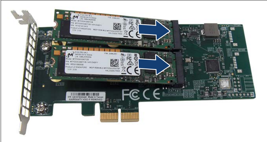
Bild 154: M.2-SSDs einbauen (A)
