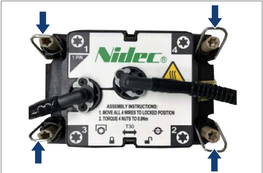
Bild 233: LC-Kühlkörper entfernen (B)
