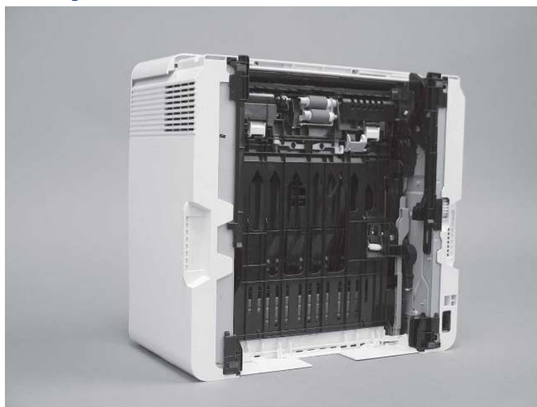
Abbildung 6-18 Stellen des Druckers mit der Unterseite nach vorn
