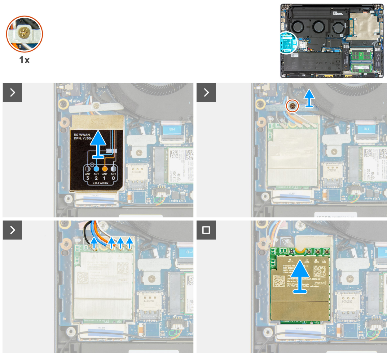
Abbildung 50. Entfernen der WWAN-Karte
