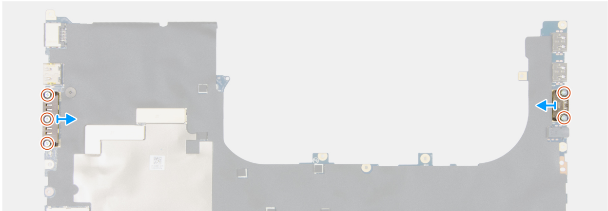
Abbildung 115. Entfernen des USB-Typ-C-Anschlussmoduls
