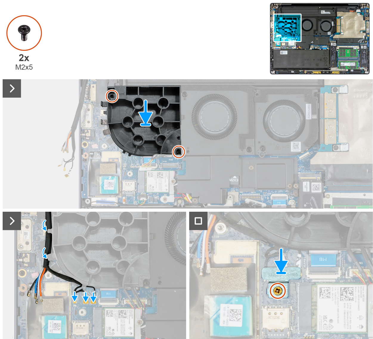
Abbildung 60. Einbauen des Dummy-Lüfters
