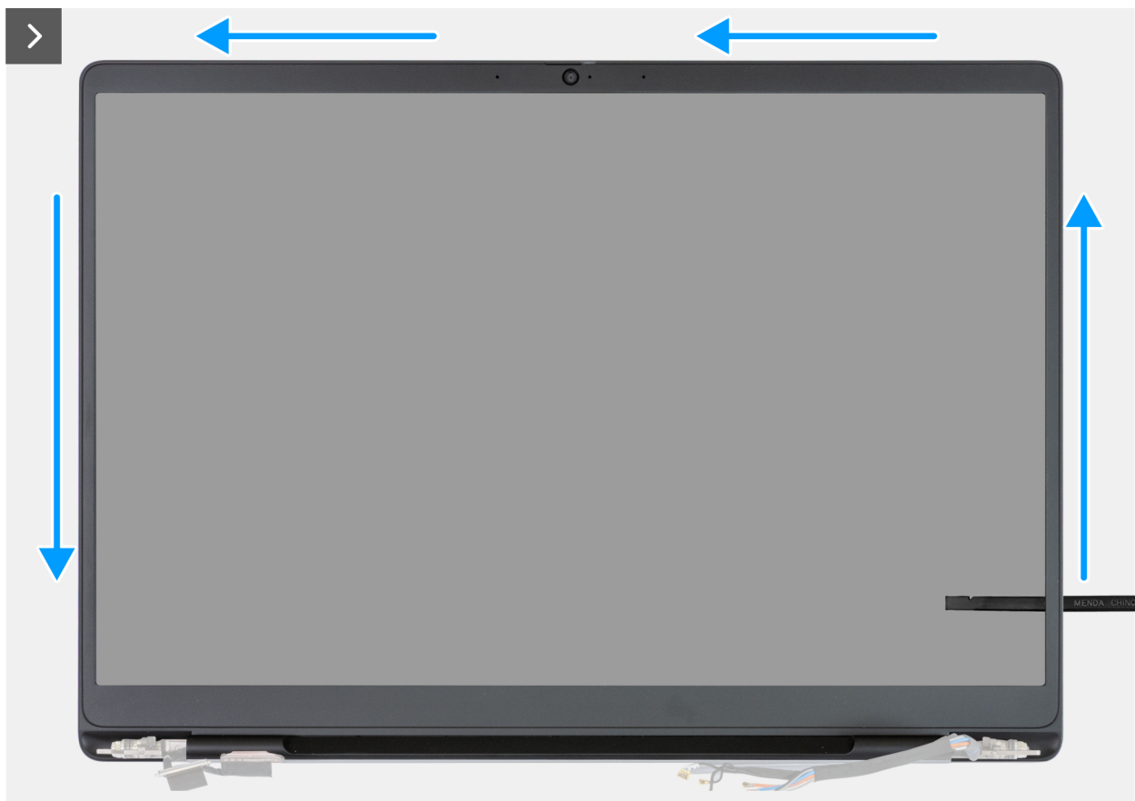
Abbildung 85. Entfernen der Bildschirmblende
