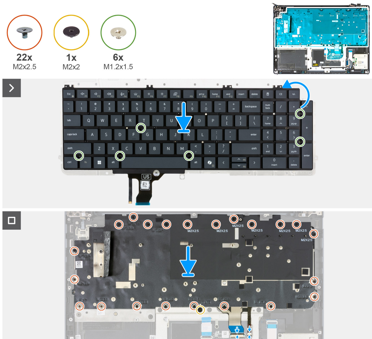
Abbildung 120. Einbauen der Tastatur
