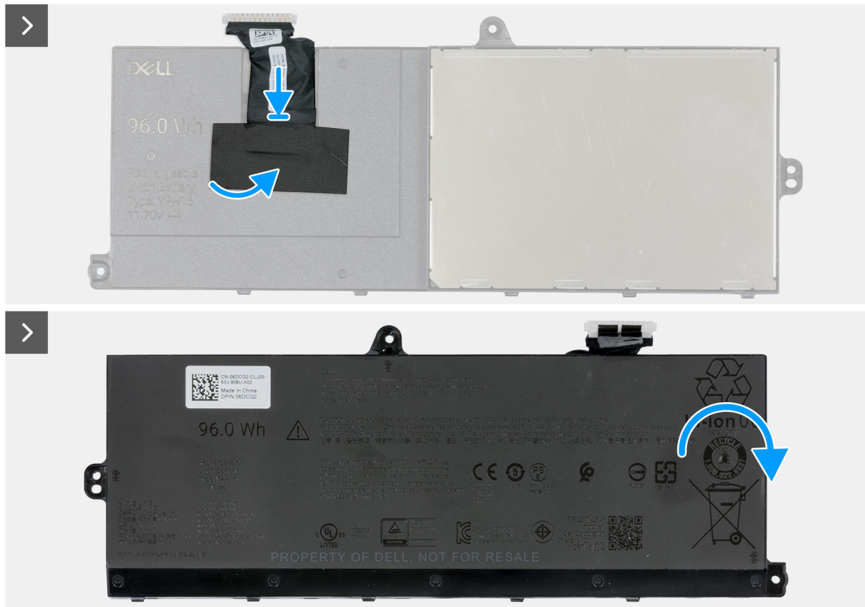
Abbildung 44. Austauschen des Akkukabels
