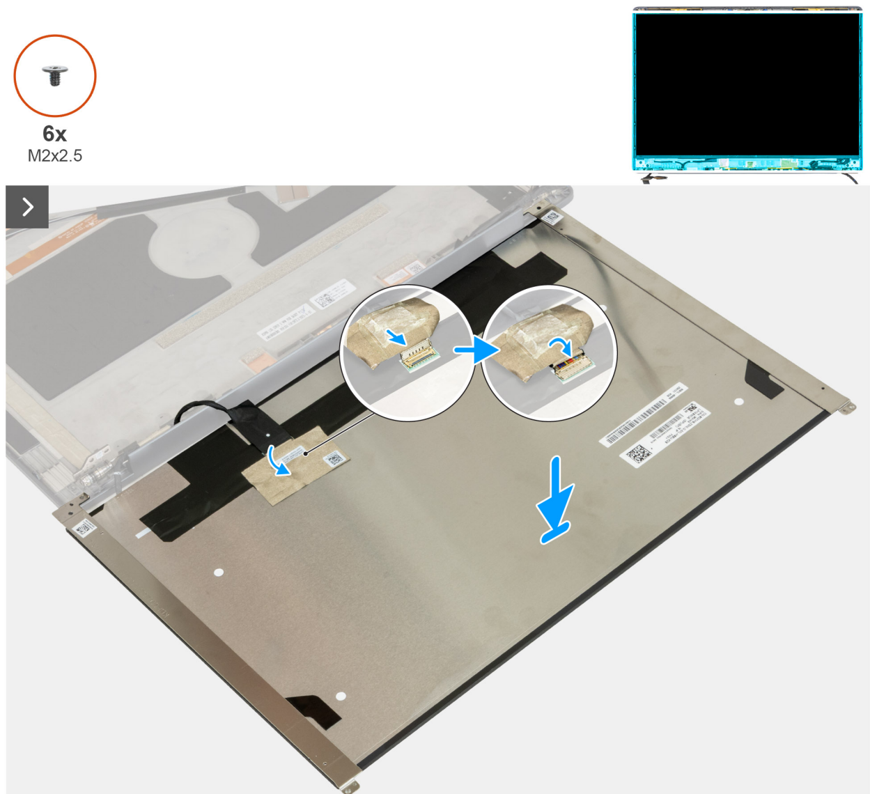
Abbildung 93. Einbauen des Bildschirms für Touchscreen-Displays
