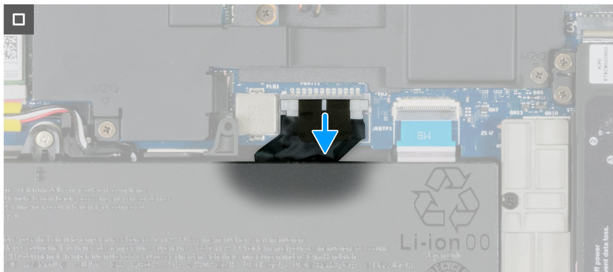
Abbildung 26. Trennen des Akkukabels
