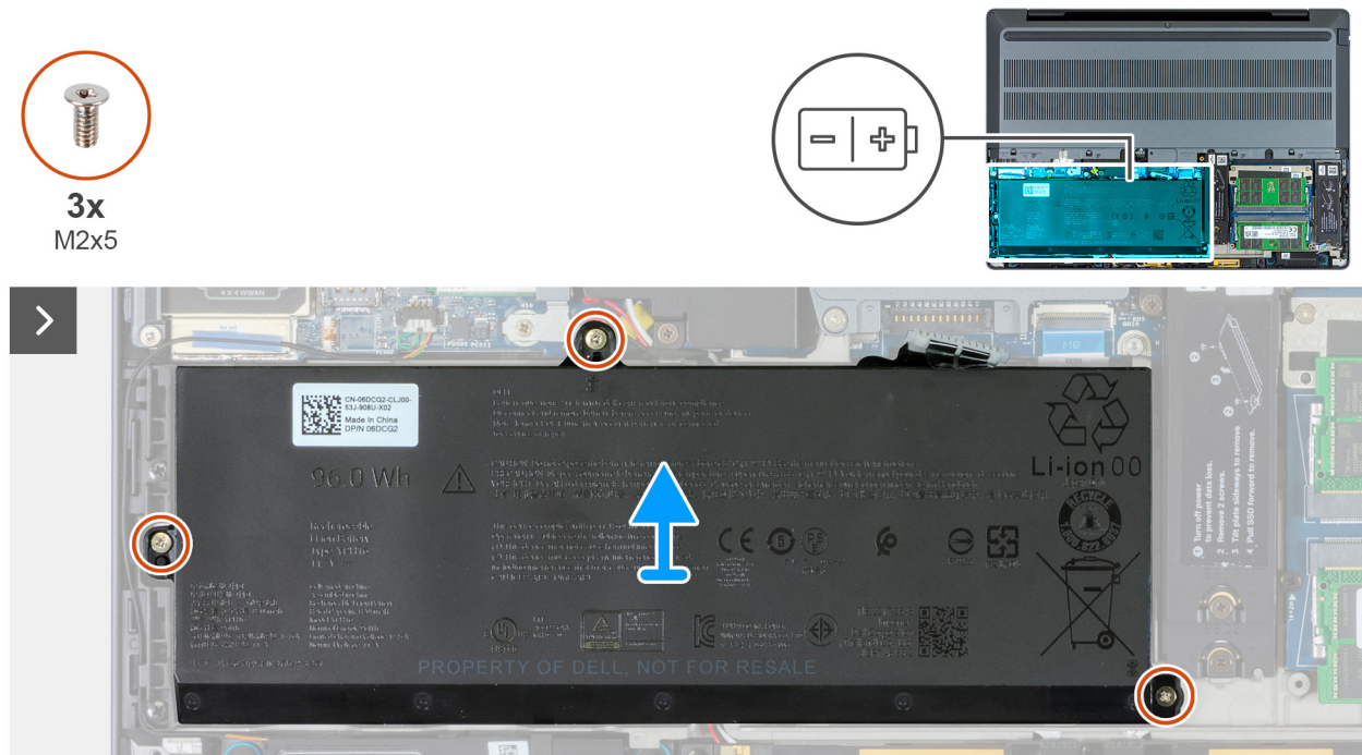
Abbildung 42. Entfernen des Akkus
