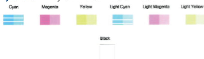
Rysunek 9-2 Przykładowe bloki kolorów z defektami
