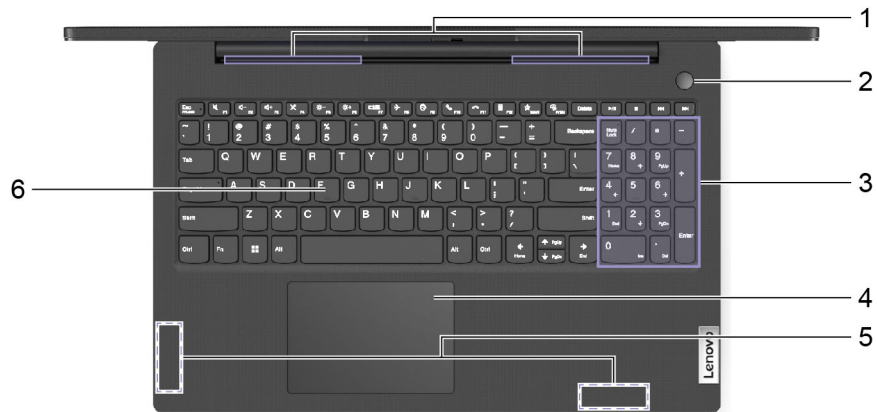
Abbildung 3. Ansicht des Unterteils—Lenovo V15 G4 IAN und Lenovo V15 G4 AMN
