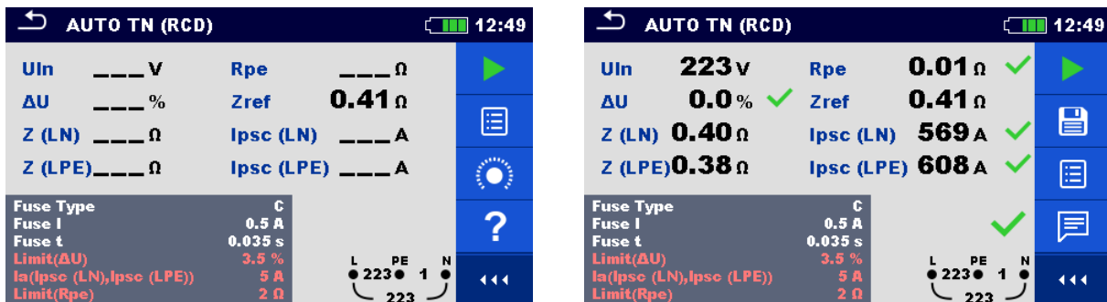
Abbildung 7.77: Beispiele für Ergebnisse der AUTO TN (RCD)-Messung
