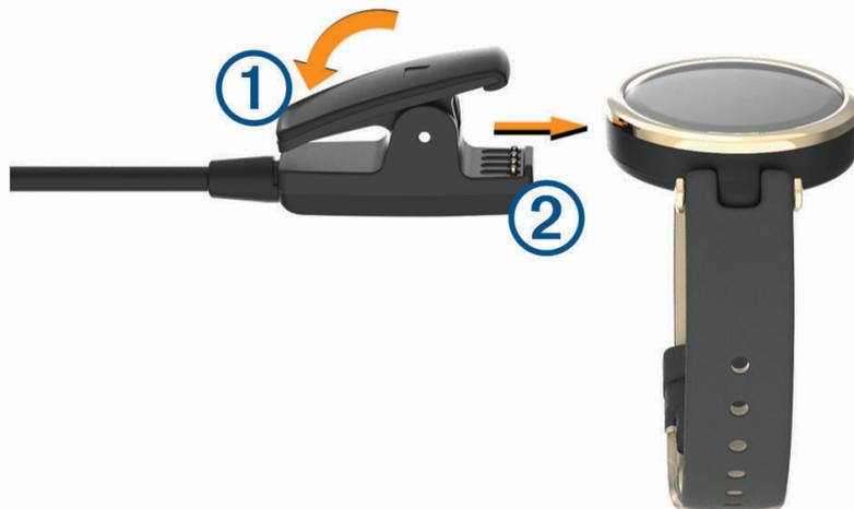
2 Richten Sie die Klemme auf die Kontakte aus ②, und lassen Sie die Greifarme los.
