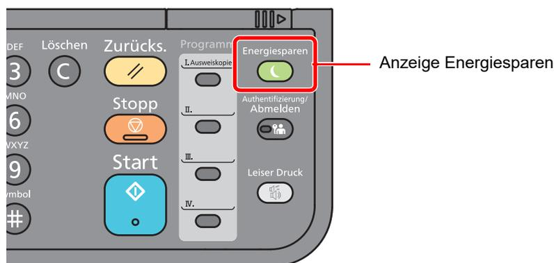
Sollten während des Ruhemodus Druckdaten empfangen werden, startet das Gerät automatisch und druckt.
