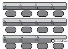
Wenn Sie die Zielwahltasten 12 bis 22 auswählen möchten, müssen Sie die Taste [Umschaltsperr] aktivieren, indem Sie die Taste [Umschaltsperr] und dann die Zielwahltaste wählen.
