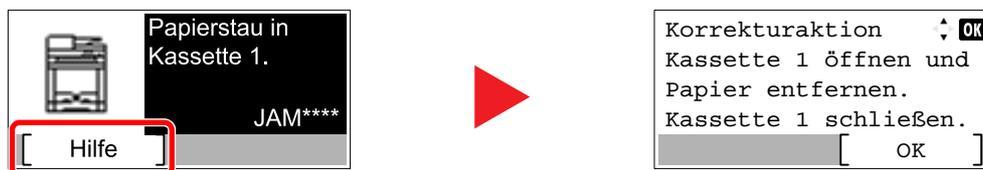
Mit der Taste [**▼**] gehen Sie zum nächsten Schritt und mit der Taste [**▲**] kehren Sie zum vorherigen Schritt zurück.
