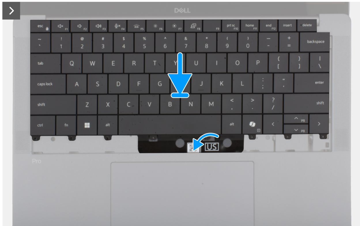
Abbildung 73. Installieren der Tastaturbaugruppe
