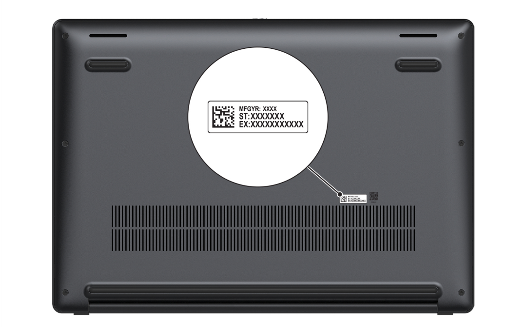
Abbildung 7. Position des Service-Tags/Express-Servicecodes
