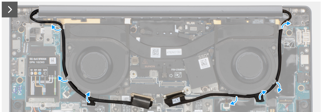
Abbildung 56. Trennen der Display- und Kamerakabel
