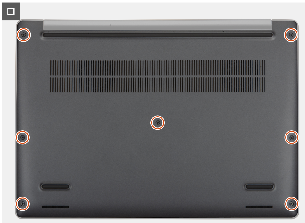
Abbildung 19. Festziehen der unverlierbaren Schrauben
