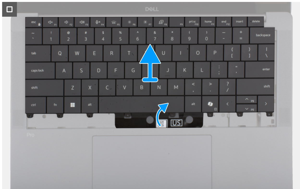
Abbildung 72. Entfernen der Tastaturbaugruppe
