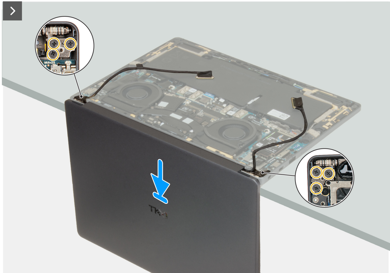
Abbildung 59. Einbauen der Displaybaugruppe
