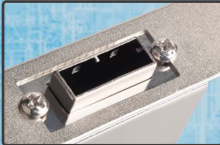
Extern: Mini-SAS-SFF-8088 x 1 (zum externen Laufwerkgehäuse, z. B. TS431S)
