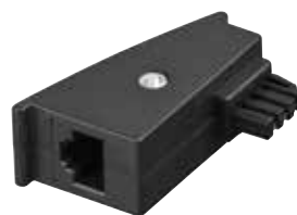
Goobay TAE Adapter TAE-F-Stecker > RJ45-Buchse (8P2C) • TAE PIN 1(a) -> RJ 45 PIN 1, TAE PIN 2(b) -> RJ 45 PIN 8 • passend für FRITZ Box
