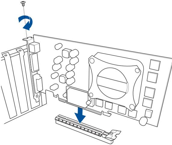
So installieren Sie eine PCIE x1 Karte
