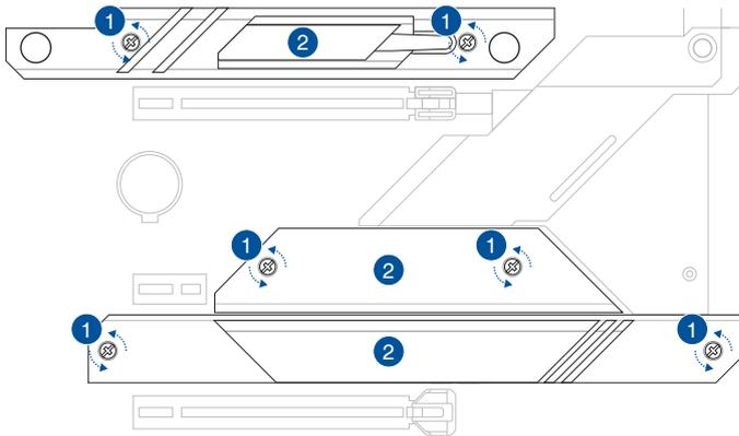
3. Installieren Sie Ihr M.2 in Ihrem M.2 Steckplatz. Die Schritte können bei der Installation von M.2 verschiedener Länge unterschiedlich sein. Bitte geben Sie auf die verschiedenen Typen und deren Installationsschritte unten acht:
