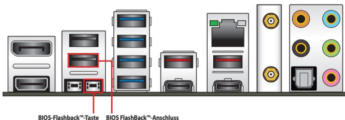
5. Warten Sie bis das Licht ausgeht, was bedeutet, dass die Aktualisierung des BIOS beendet ist.
