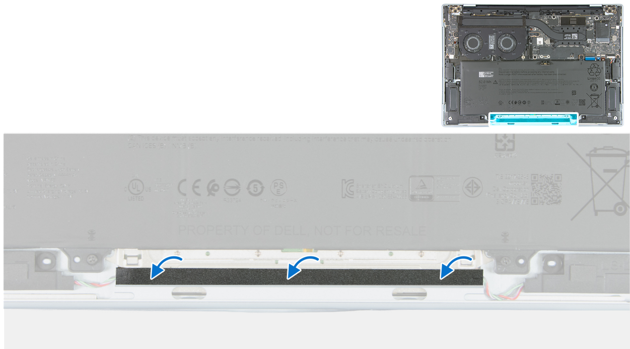
Abbildung 12. Anbringen der Schutzfolie des Lautsprecherkabels
