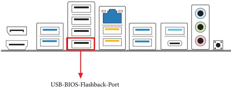
ASRocks BIOS-Flashback-Funktion ermöglicht Ihnen die Aktualisierung des BIOS ohne Einschalten des Systems, sogar ohne CPU.
