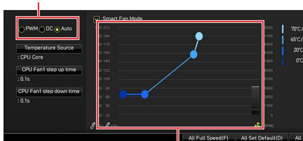
Il y a des points de gradient de la vitesse du ventilateur qui vous permet d'ajuster la vitesse du ventilateur par rapport à la température du processeur.
