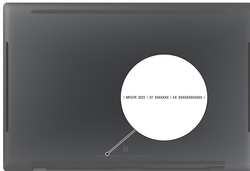
Abbildung 6. Position der Service-Tag-Nummer/des Express-Servicecodes
