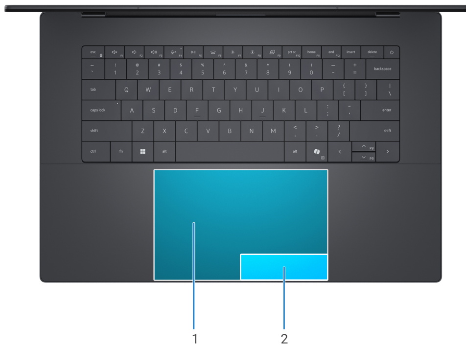
Abbildung 8. Aktive Bereiche des nahtlosen Touchpads
