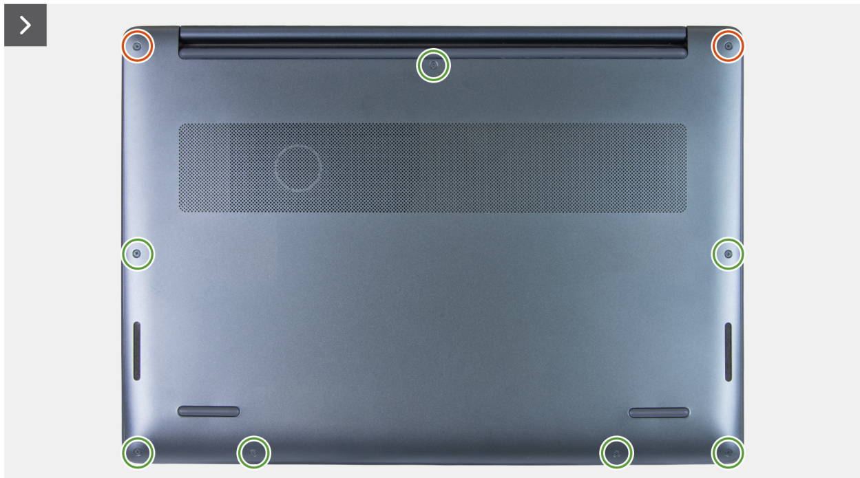
Abbildung 2. Entfernen der Bodenabdeckung
