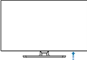
2. Platzieren Sie den Bildschirm mit dem Panel nach unten auf einem weichen Untergrund. Achten Sie darauf, dass der Bildschirm nicht zerkratzt oder beschädigt wird. Heben Sie den Ständer dann an.
