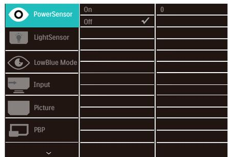
Im oben gezeigten Bildschirmmenü können Sie durch die Betätigung der Tasten ▼▲ an der Rückblende des Monitors den Cursor bewegen und mit OK die Auswahl bzw. Änderung bestätigen.
