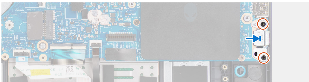
Abbildung 27. Installieren der rechten USB-Typ-C-Halterung
