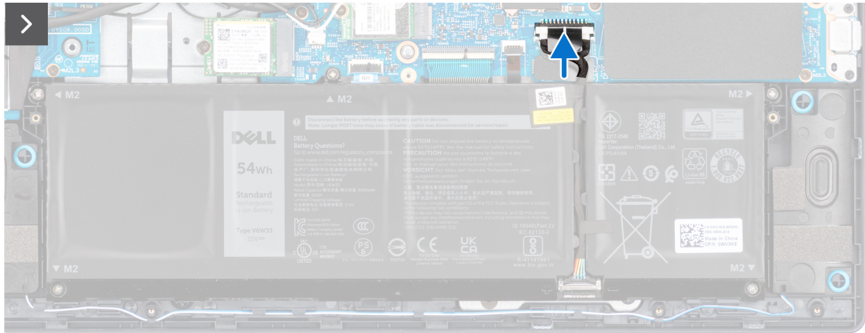
Abbildung 6. Verbinden des Akkukabels
