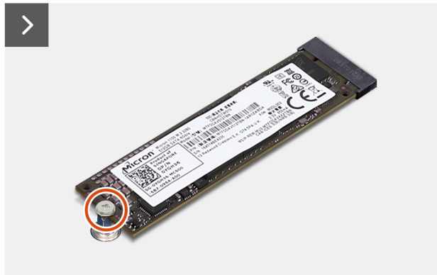
Abbildung 17. Entfernen der M.2-2280-SSD
