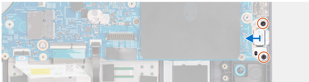
Abbildung 26. Entfernen der rechten USB-Typ-C-Halterung
