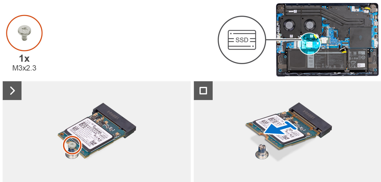
Abbildung 15. Entfernen des M.2-2230-Solid-State-Laufwerks
