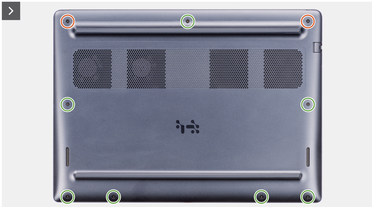
Abbildung 3. Entfernen der Bodenabdeckung
