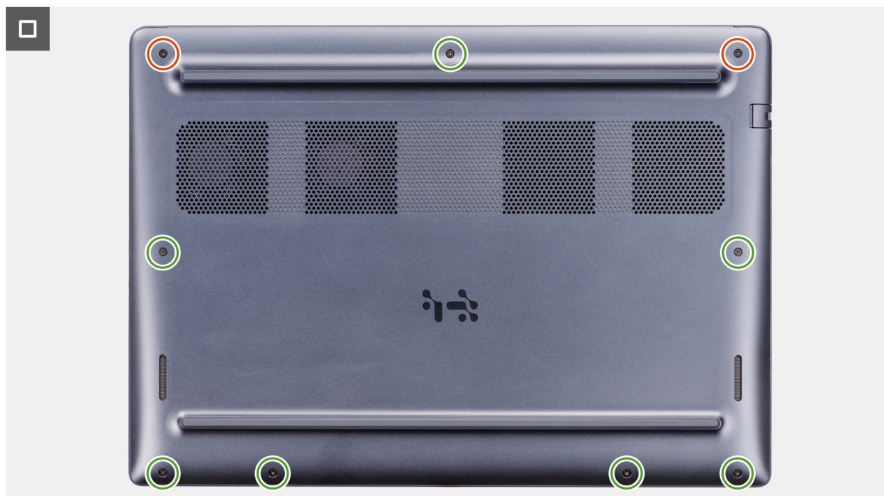
Abbildung 8. Anbringen der Bodenabdeckung
