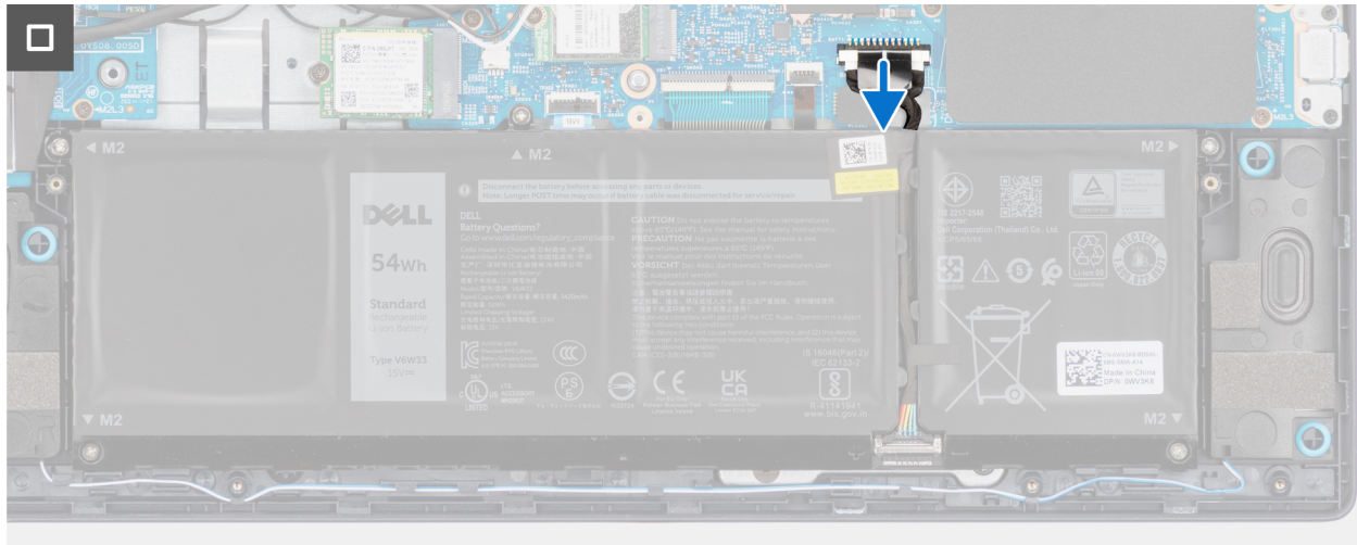
Abbildung 5. Trennen des Akkukabels
