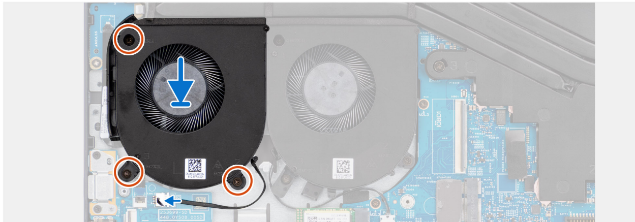
Abbildung 33. Installieren des linken Lüfters
