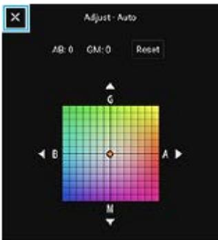
**Temp. 1 / Temp. 2 / Temp. 3:** Speichert Weißabgleichseinstellungen, die in Bezug auf die Farbtemperatur definiert sind. Tippen Sie auf [Anp.], um die Farbtemperatur mit dem Moduswahlrad einzustellen, und dann auf [Anp.], um den Farbton mithilfe des Feineinstellungsbildschirms präzise einzustellen. Tippen Sie nach der Einstellung auf **X** (Taste „Schließen“).
