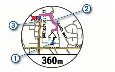
Auf der Karten werden die aktuelle Position (1), der zu verfolgende Track (2) sowie das Ziel (3) angezeigt.
