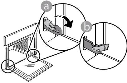
2. Die Tür so weit wie möglich schließen. Die Tür mit beiden Händen festhalten – diese nicht am Griff festhalten. Die Tür einfach entfernen, indem sie weiter geschlossen und gleichzeitig nach oben gezogen wird, bis sie sich aus ihrem Sitz löst. Die Tür seitlich abstellen und auf eine weiche Oberfläche legen.
