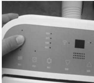
Halten Sie die Power-Taste 5-10 Sekunden lang gedrückt und drücken Sie dann die Taste «SLEEP», bis Sie einen Ton hören und das WiFi-Licht blinken sehen.
