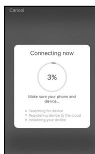
9. Une connexion est établie entre l'application et l'appareil. En cas d'échec, appuyez sur la touche WIFI de l'appareil pendant 5 secondes pour réinitialiser.
