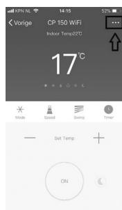
12. Selezionare «...» in alto a destra della schermata delle operazioni e quindi selezionare «Modify Device Name» per dare al dispositivo un nome logico in modo da sapere di quale dispositivo si tratta.
