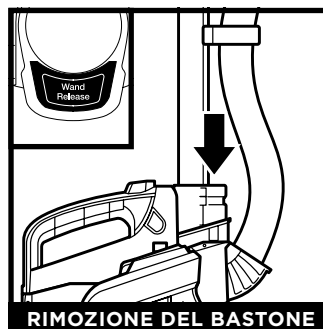
RIMOZIONE DEL BASTONE
