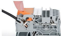
Direktes Stecken (Push-in) – eindrähtige Leiter
