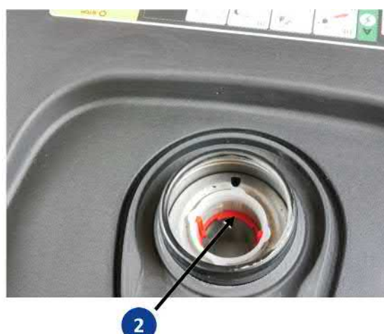
Fig. 7-2 Tankning av generator
