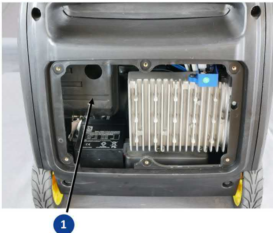
Рис. 9-5 Воздушный фильтр за вентиляционной решеткой (снята)
