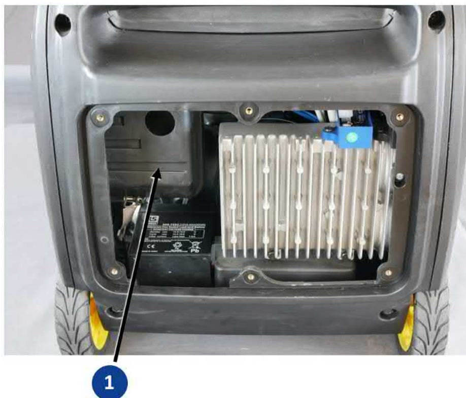
Abb. 9-5 Luftfilter hinter Lüftungsgitter (entfernt)
