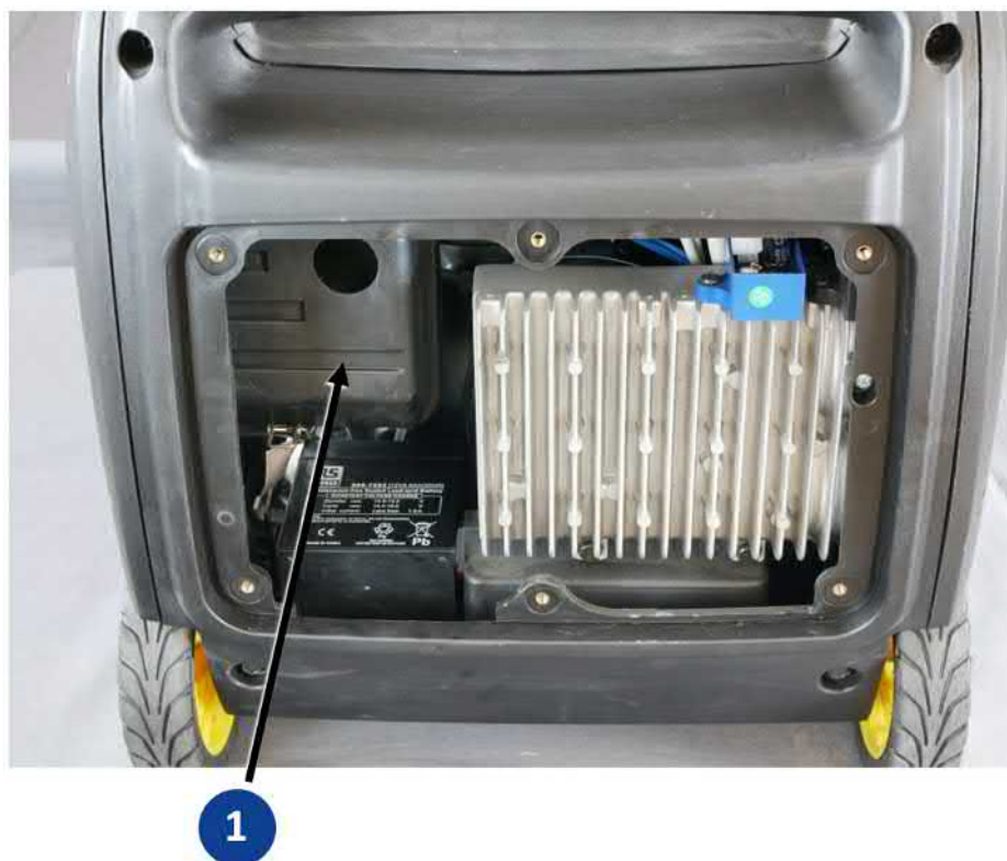
Fig. 9-5 Le filtre à air est derrière la grille de ventilation (retiré)
