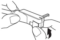
3. Stellen Sie sicher, dass kein Spalt zwischen der Headshell und dem Tonabnehmer vorhanden ist.
