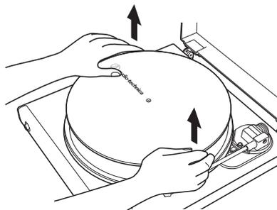
2. Heben Sie den Plattenteller, drehen Sie ihn um und entfernen Sie dann den alten Riemen.
