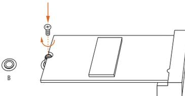
Fixieren Sie das Modul, indem Sie die Schraube mit einem Schraubendreher anziehen. Ziehen Sie die Schraube nicht übermäßig stark an; andernfalls kann das Modul beschädigt werden.
