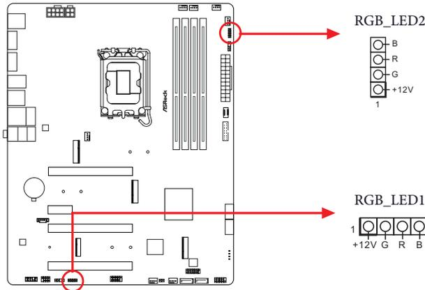
Schließen Sie Ihren RGB-LED-Streifen an der **RGB-LED-Stiftleiste (RGB\_LED1, RGB\_LED2)** auf dem Motherboard an.
