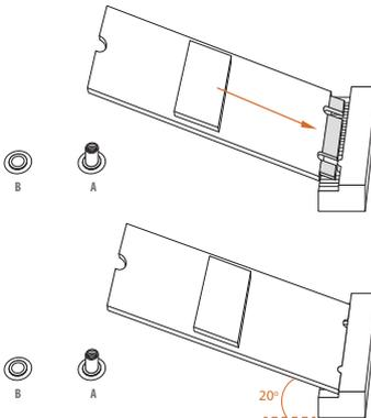
Setzen Sie das M.2-SSD-Modul sorgfältig an den M.2-Steckplatz an, schieben Sie das Modul vorsichtig ein. Bitte beachten Sie, dass das M.2-SSD-Modul nur richtig herum in den Steckplatz passt.
