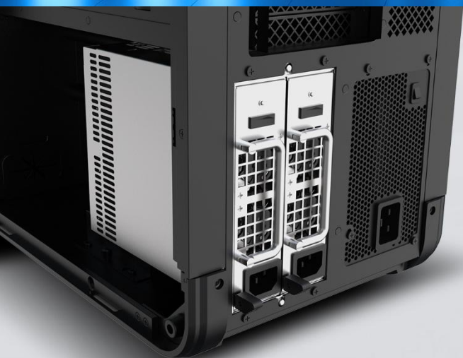
Flexible Dual-Netzteil-Architektur Kompatibel mit 2U-CRPS-, Mini-Redundant- und Standard-ATX-(PS2)-Netzteilen
