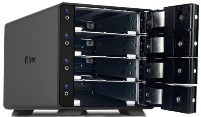
4. Schieben Sie die Festplatten in das Gehäuse.
